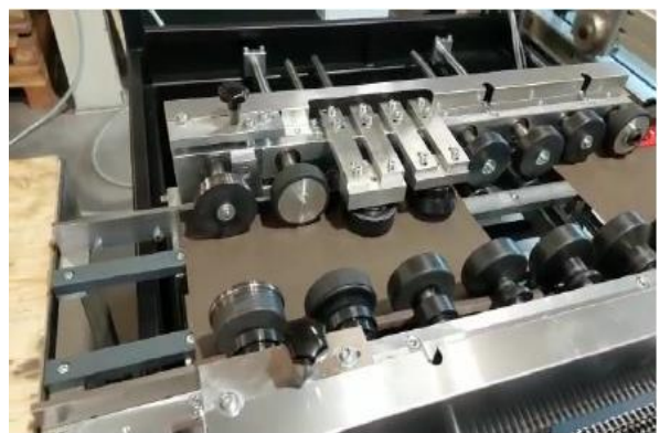
Profiliereinheit mit optionalen Biege- und Clipreliefmodul
