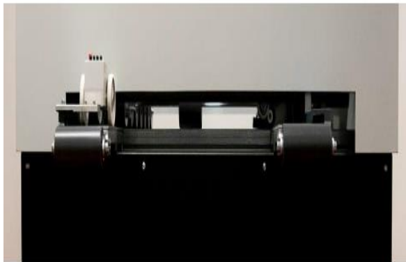
Längsschneideeinrichtung (zusätzlicher Zuschnitt der Bleche möglich)
