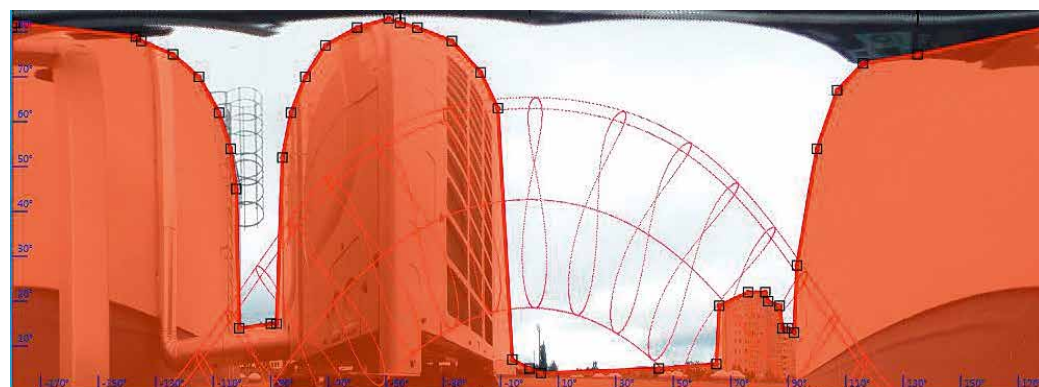
Abb. 3: Aufnahme des Horizontes an einem Punkt auf einem Flachdach zwischen einem höheren Gebäudeteil und einer Klimaanlage: Horizont (rot) und Sonnenbahnen.
