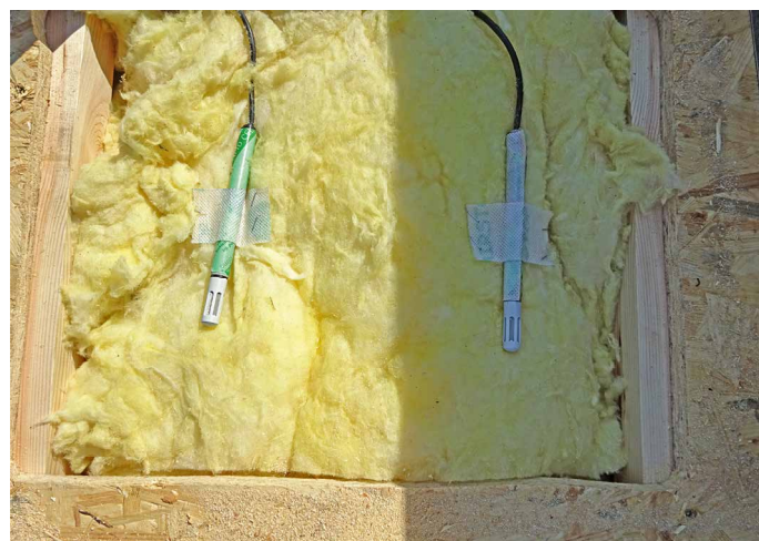
Abb. 7: Feuchte- und Temperatursensoren unter und hinter einem PV-Element an der Gefachaußenseite zur Überwachung des hygrothermischen Verhaltens der Dachkonstruktion (Abstand der Sensoren etwa 20 cm).
